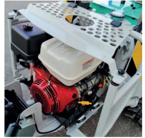
Motore protetto da una robusta struttura che evita il danneggiamento in caso di caduta di materiale.
